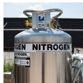
Quindi l'inertizzazione del volume di gas a contatto con il liquido si ottiene rimuovendovi l'aria con un flusso di gas inerte e subito dopo limitando lo scambio con l'aria esterna.
